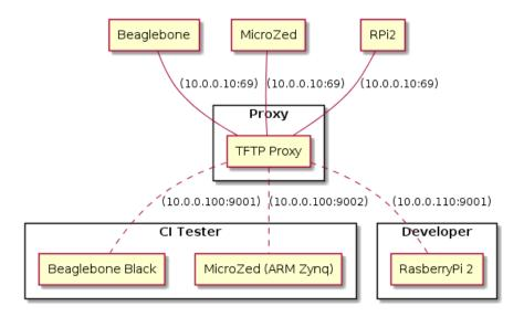
Fig. 14.1: RTEMS TFTP Proxy Test Lab
